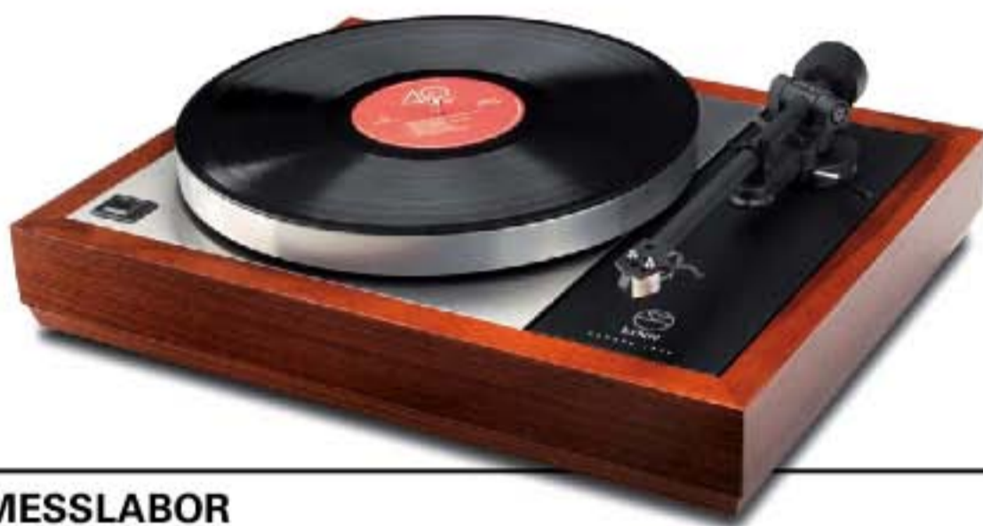
PERFEKTES PAKET: Der Akurate-LP12 ist der mittlere von drei Komplettspieler-Vorschlägen im Linn-Programm. Er umfasst das Kore-Subchassis, die Motorsteuerung Lingo, den Tonarm Akito, die Trampolin-Bodenplatte und das MC-System Klyde.
